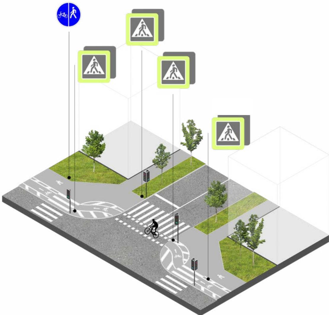
На пересечениях с примыкающими улицами и проездами двустороннюю велосипедную полосу необходимо сдвигать от проезжей части улицы, вдоль которой проходит велосипедный маршрут, на расстояние 10–15 м, в стесненных условиях – не менее 5 м. Сдвиг обеспечивается в пределах проезжей части примыкания или путем переноса велосипедного пути на тротуар (устройства участка велопешеходной дорожки).
