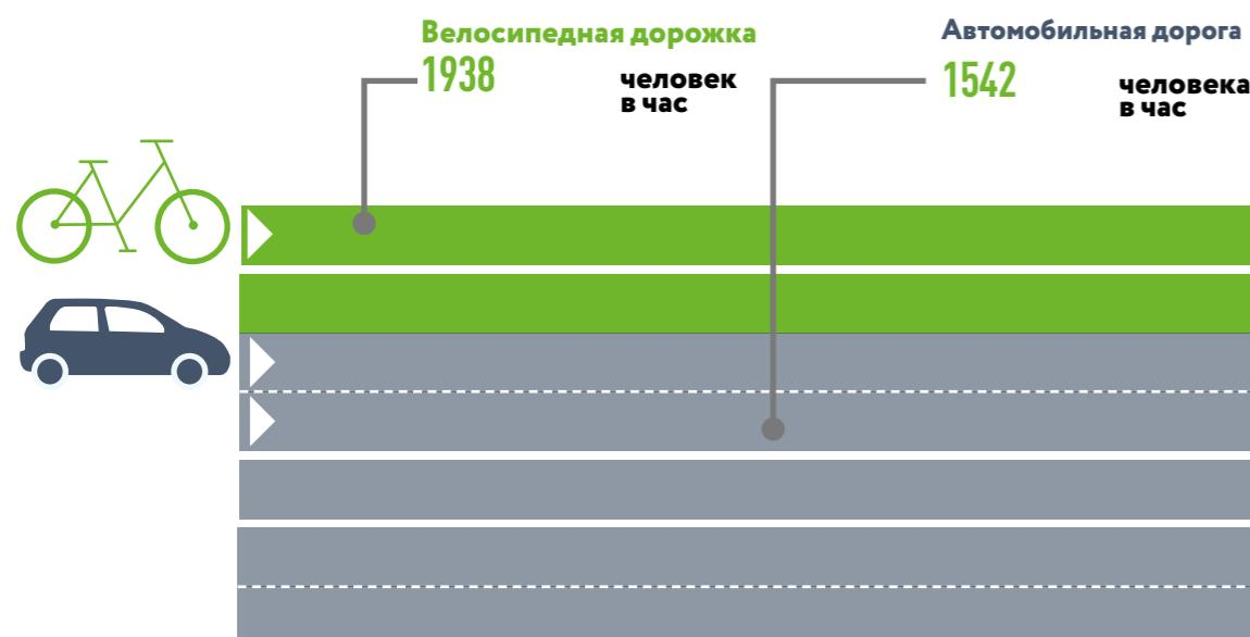
Пропускная способность на примере моста Блэкфрайерс, Лондон, Великобритания. Утренний час пик, с 8:00 до 9:00
