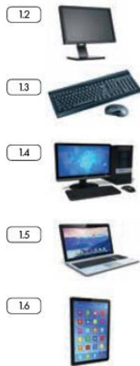
Настольный стационарный компьютер **1.4**. Он состоит из системного блока, монитора, клавиатуры и мыши. У большинства людей дома имеются именно такие компьютеры.
