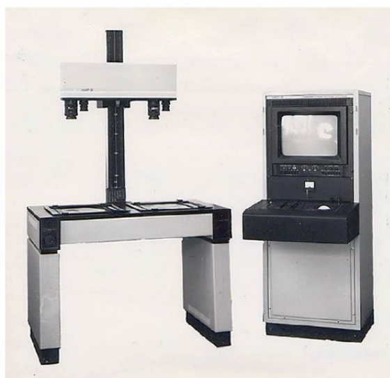
Рисунок 4 — Установка для анализа рентгенограмм УАР-2.
