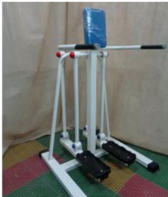
**Описание:** Ключевой принцип действия тренажера состоит в синхронном передвижении механических элементов, на которые опираются нижние конечности, имитируя движения ходьбы.
