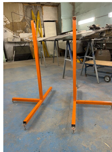
Оснастка для проведения стендовых испытаний изготовленная из трубного металлопроката
