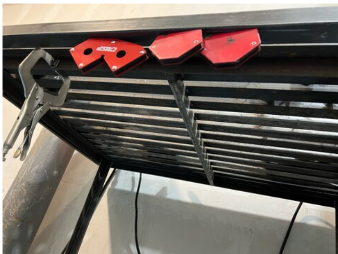
Стеллаж для испытания моделей с металлозаземлением, изготовленный из трубного металлопроката
