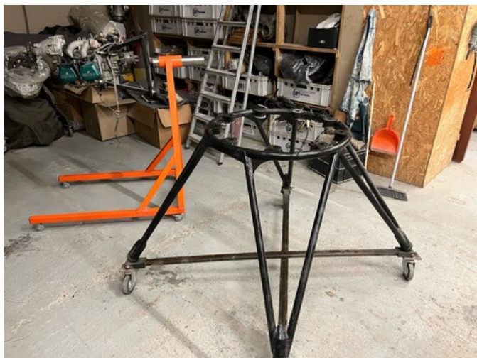
Оснастка для проведения стендовых испытаний изготовленные из трубного металлопроката
